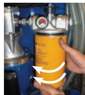
Afb. 6: Losdrehen des Filters gegen den Uhrzeigersinn.
