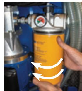
Fig. 6 : Dévisser le filtre dans le sens inverse des aiguilles d'une montre
